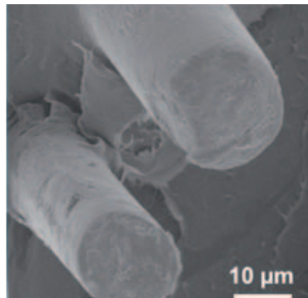
Bild 1. (links) Rastkraftmikroskopische (AFM) Aufnahme eines Sphäroliten in einem teilkristallinen Polymer. (rechts) Rasterelektronenmikroskopische (REM) Aufnahme von Glasfasern in einer Polymermatrix.
